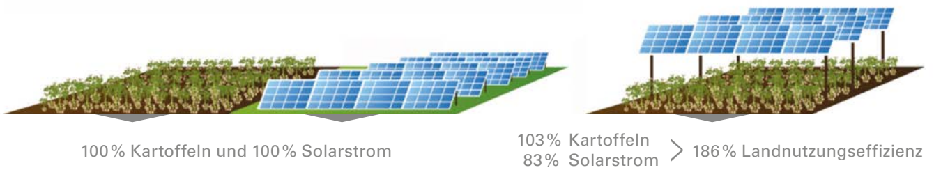
Abbildung 7 | Flächennutzungseffizienz bei kombinierter Nutzung durch Agri-PV. (Fraunhofer Institut für Solare Energiesysteme, 2020, S. 2014)
